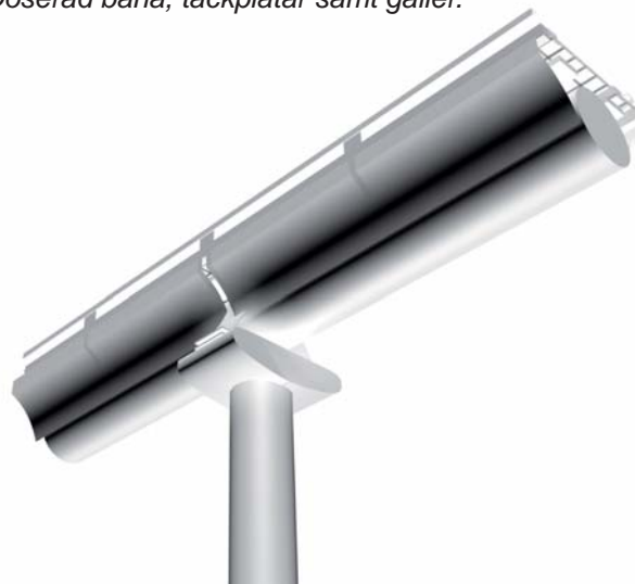
Överbyggnaden vid stöd och lager, skarven mellan täckplåtarna är synlig.
